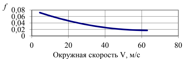
Рис. 3. Коэффициенты трения в зацеплении для различных окружных скоростей
